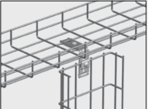
For vertikal nedbøyning under trådstiger, alle bredder, brukt: 1 stk Vinkelbeslag B27 1 stk Beslag B1 1 stk Beslag B2 2 stk Skruesats B13.
